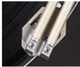
Beim Weg des Tonabnehmers über die Schallplatte verändert das Doppelgestänge des Simplicity dessen Kröpfung, also den Winkel zum Arm. Dieser ist am Außenrand der Platte (l.) größer und wird über deren Mitte (M.) bis zum Innenrand (r.) hin immer kleiner
