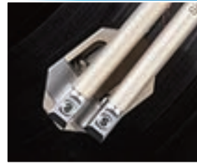
Beim Weg des Tonabnehmers über die Schallplatte verändert das Doppelgestänge des Simplicity dessen Kröpfung, also den Winkel zum Arm. Dieser ist am Außenrand der Platte (l.) größer und wird über deren Mitte (M.) bis zum Innenrand (r.) hin immer kleiner
