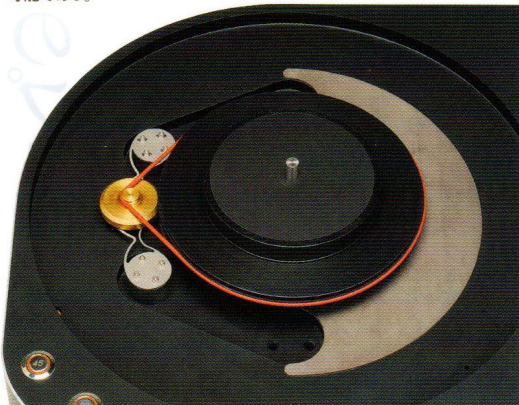
アウトプラーターを取り外すと、インナープラーターとモーターが姿を現す。モーターはインナープラーター直近に置かれ、微振動が伝わりぬよう、金属片で懸架される。プリーリーには回転ムラを抑えるためであろう、フライホイールが取り付けられている。このモーターはバッテリーで駆動しており、一回の充電で最大16時間稼働可能。
